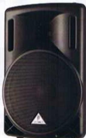
Enceinte ABS de sonorisation 2 voies 600 Watts en crête (150 W en continu) avec woofer 15 Pouces et moteur à compression 1,75 pouces.
